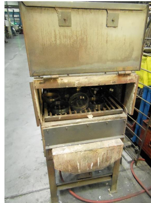
Ohřev zálitků v plynovém ohřívacím boxu na teplotu 450 – 550°C
